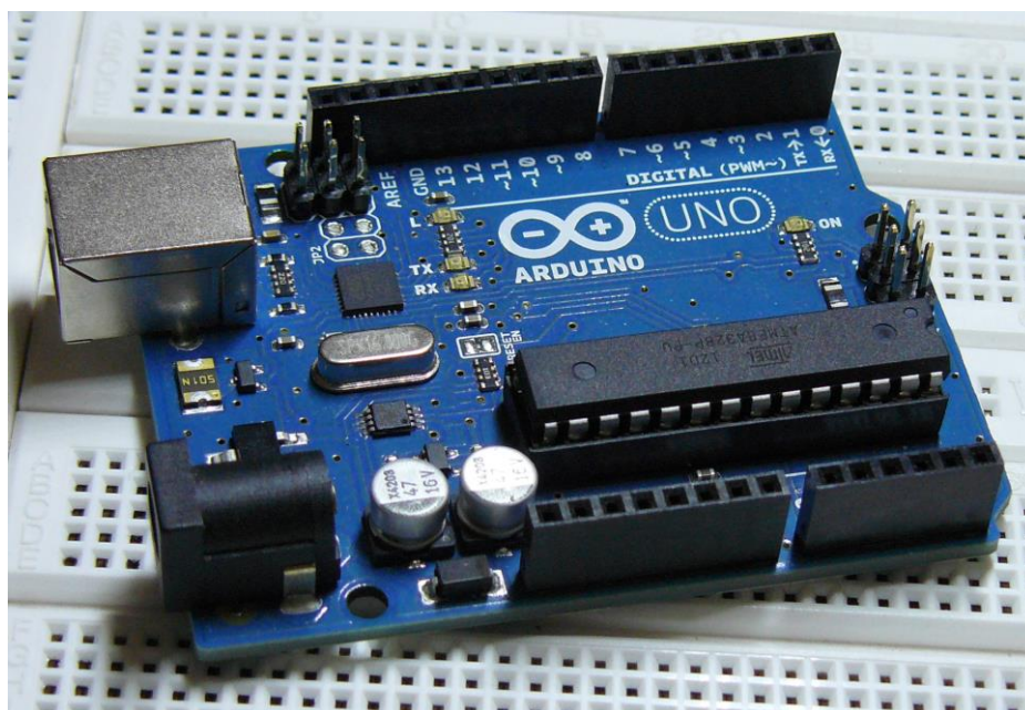
Obrázok 0-1. Doska Arduino UNO R3
