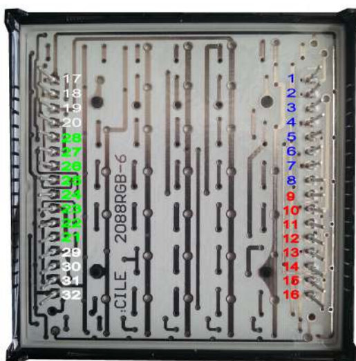
Obrázek 52.3: Piny RGB displeje
