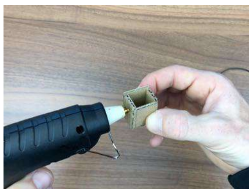
Obr. 19 – Slepění pouzdra na motor
