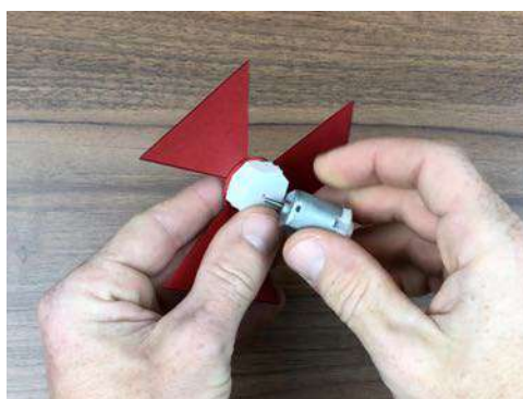
Obr. 11 – Nasazení vrtule na motor
