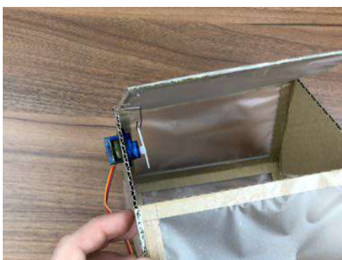
Obr. 16 – Spojení serva se střechem
